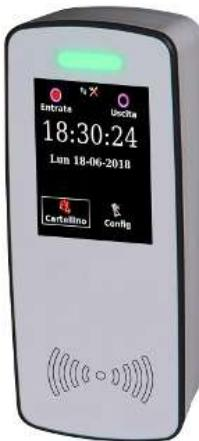
Display LCD retroilluminato ad alta risoluzione 240x320, TFT 65536 colori
